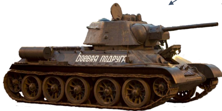
Советский средний танк Т-34-85 тип брони - стальная катаная гомогенная
