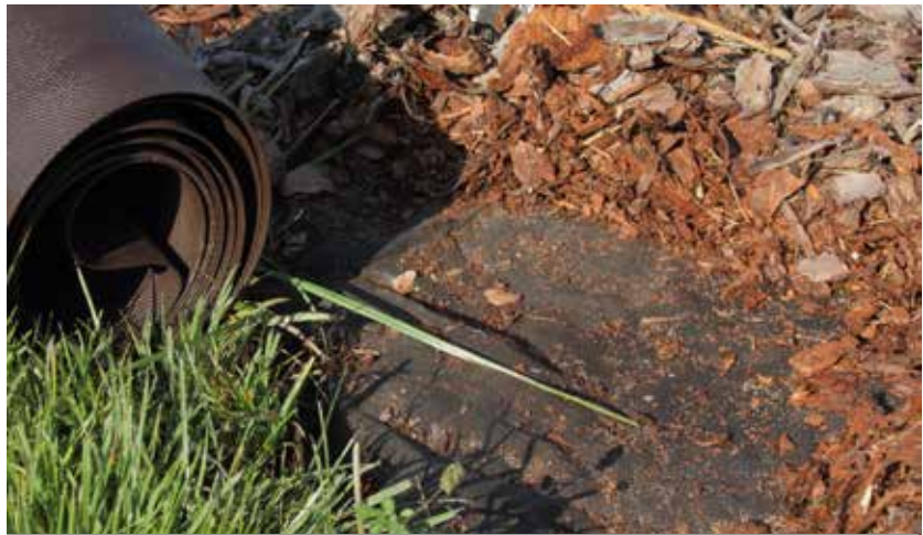
На переднем плане вы видите геотекстиль, за ним – слой мульчи, а слева – рулон бордюрной ленты
