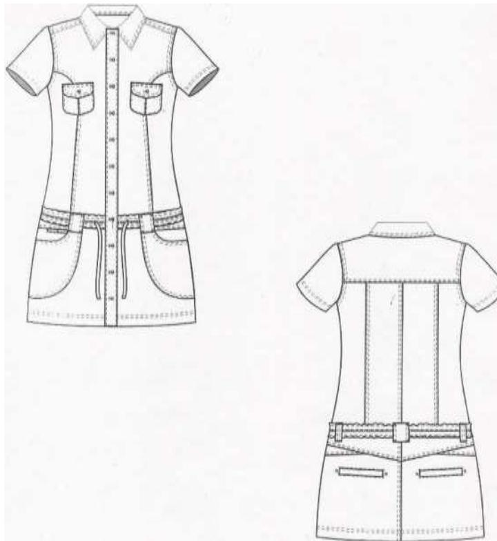
Рис. 1 Технический рисунок платья
